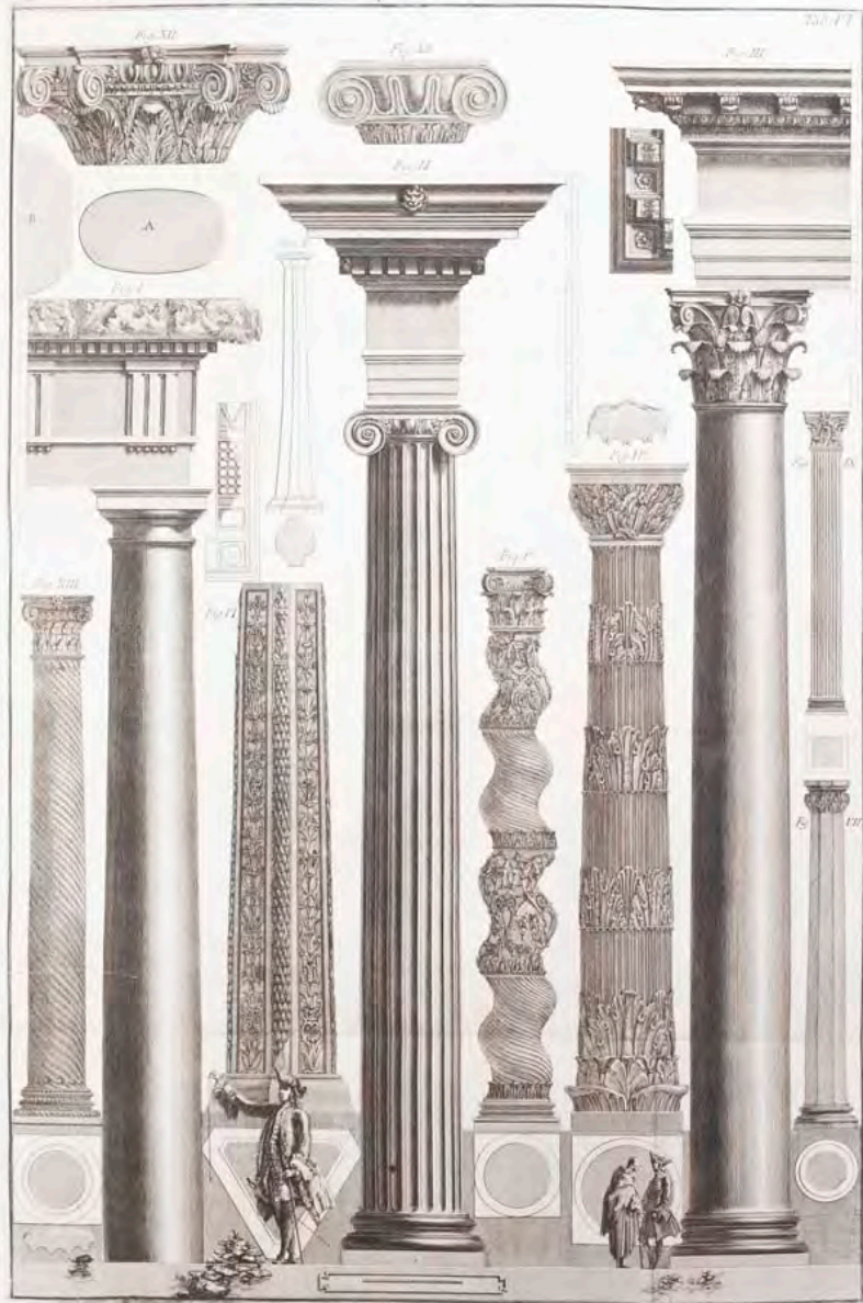
Variae in Architectura graecanica rationes ac symmetriae ex antiquis monumentis excerptae Fig. I. Columna dorica in templo Martialis. Fig. II. Columna ionica in aede Fortunae Neapolitanae. Fig. III. Columna corinthia in aede Panthei. Fig. IV. Columna in aede Divae Proserpinae. Fig. V. Columna in cella ex cineribus in Basilica Vaticana. Fig. VI. Columna in aede in villa Bellonaria ad Por talem Salariam. Fig. VII. Columna octangularis in claustris Lateranensibus. Fig. VIII. Columna in aede in villa Bellonaria ad Por talem Salariam extra Portam Latinam. Fig. IX. Schema antaeum in aede Panthei. Fig. X. Columna in aede in villa Bellonaria ad Por talem Salariam. Fig. XI. Caputulum pulvinatum in aede vestibuli aede Divae Proserpinae. Fig. XII. Schema in aede in villa Bellonaria ad Por talem Salariam. Fig. XIII. Columna in aede in claustris Basilicae Lateranensis.
